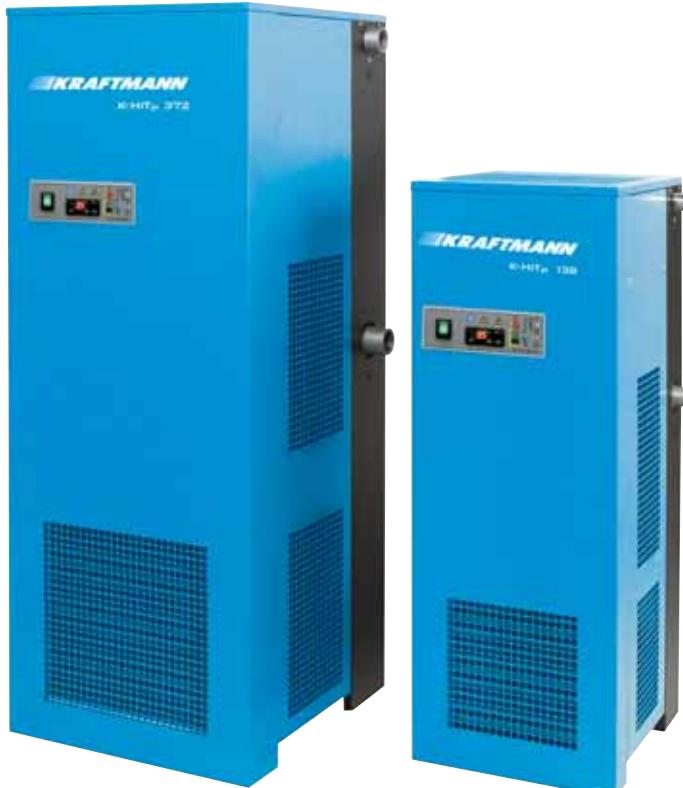
Премиальная версия осушителей для работы с горячим воздухом. Серия К-HITр оснащена увеличенным теплообменником, рассчитанным для работы при температуре воздуха до 100 °C. Дополнительно укомплектован доохладителем и фильтром, со степенью очистки до 3 микрон. Блок управления на базе контроллера DMC 14 позволяет отслеживать точку росы в цифровом формате в режиме реального времени.
